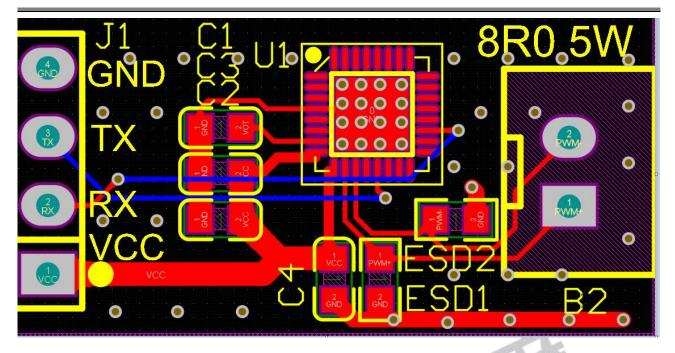
注: 1.ESD1、ESD2 静电管尽理靠近 IC 脚。 2.滤波电容 C1、C2 、C3 要加近 IC 脚。
