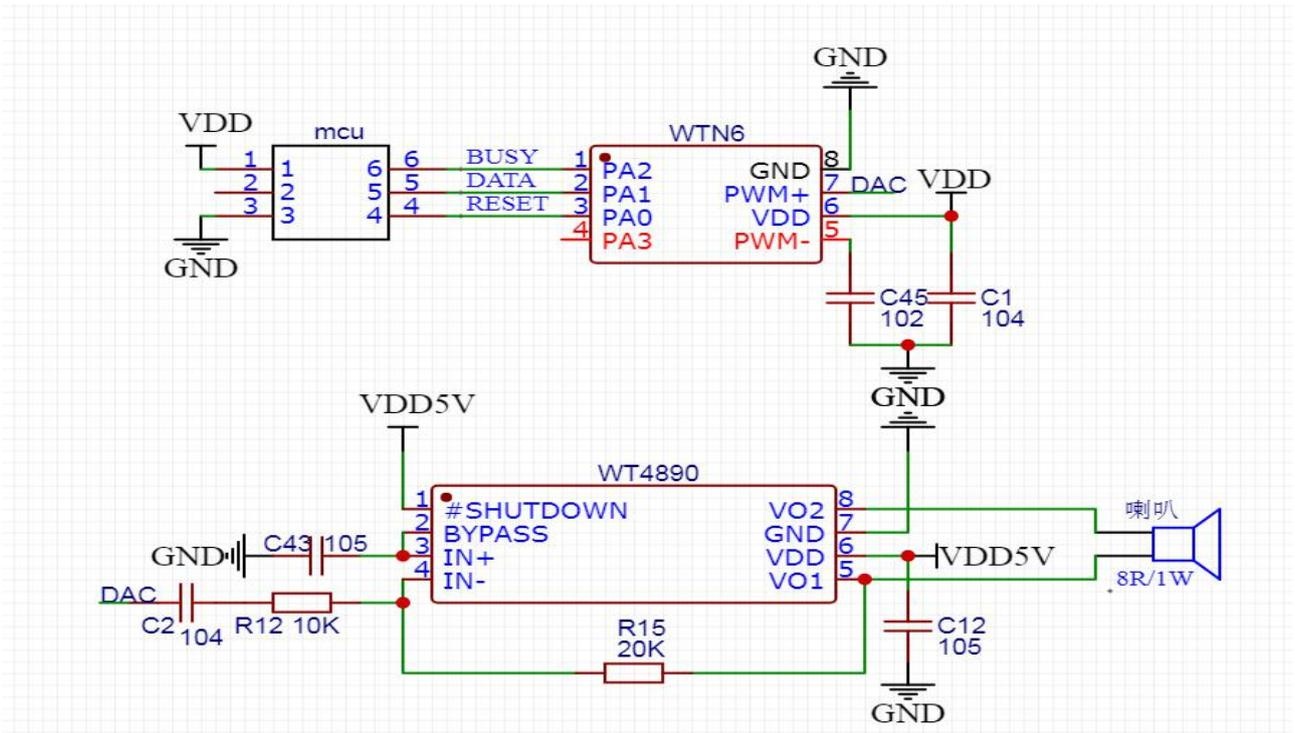
注意：布线时电容 C1 尽量靠近 WTN6 芯片 VDD 脚，以增强 WTN6 系列语音芯片的抗干扰能力。在 DAC 输出模式下，PWM-脚必须接 1nf 电容到地，DAC 输出可根据需求外接功放，以驱动更大功率的喇叭。
