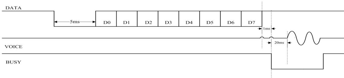
先把数据线拉低 4~20ms 后,推荐 5ms, 发送 8 位数据, 先发送低位, 再发送高位, 使用高电平和低电平比例来表示每个数据位的值。
